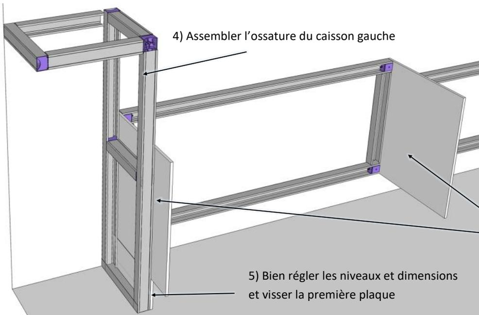
4) Assembler l'ossature du caisson gauche
