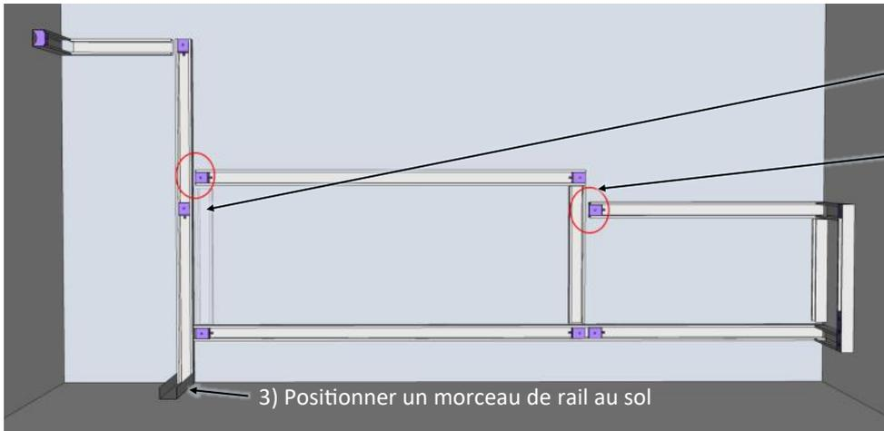
1) Visser les montants métalliques sur les murs (sauf le deuxième montant vertical du grand caisson)
